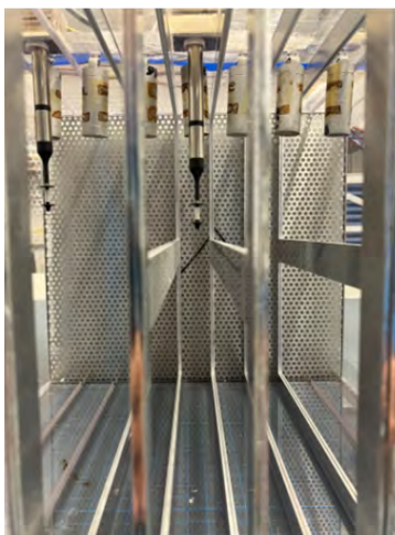
Abbildung 2 links: Strömungskanal mit Probenhaltern aus Aluminium und Sensoren zur Erfassung von Temperatur und Strömungsgeschwindigkeit an unterschiedlichen Positionen; rechts: Erzielte Strömungsgeschwindigkeit im Zwischenraum der Proben während der Ofenalterung bei 70 °C über einen Zeitraum von 12 Wochen.
